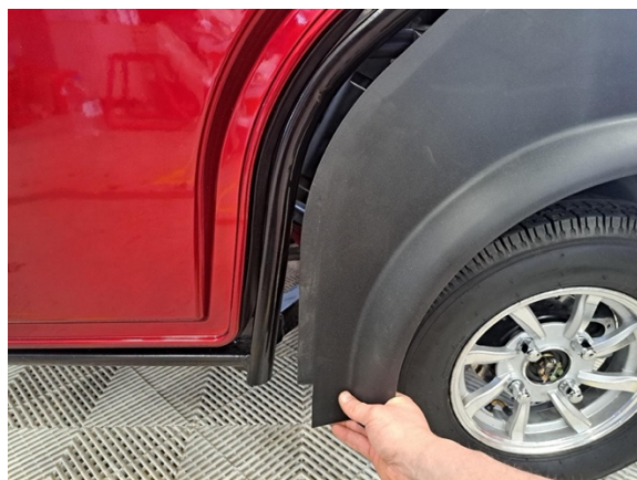
Aloita takalokasuojan irrottaminen alareunasta.
