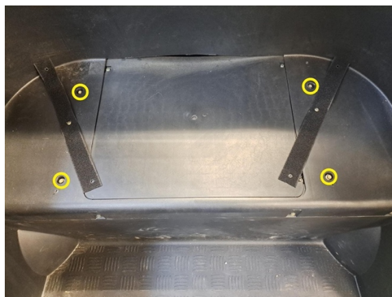
Käännä velcon tarranauhat pois tieltä. Irrota tarranauhojen alta paljastuvat kiinnityssruuvit. (hylsy 8 mm).
