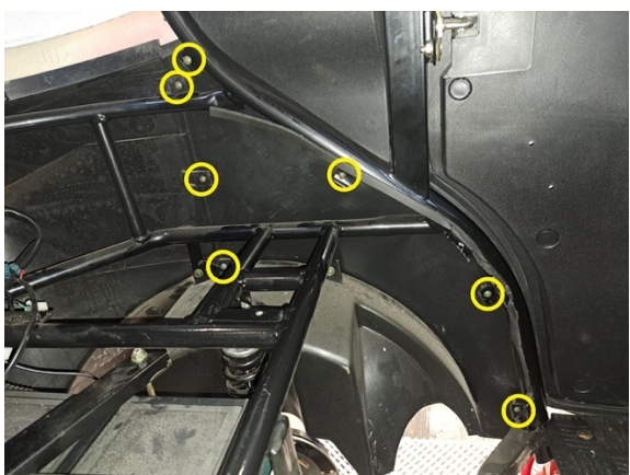
Irrota takalokasuojan kiinnitysruuvit. (ristipäämeisseli ph2).
