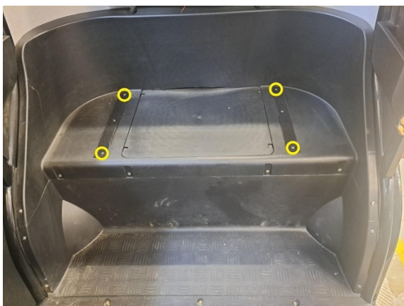
Irrota velcro tarranauhojen reunimaiset kiinnityssruuvit. (ristipäämeisseli ph2).
